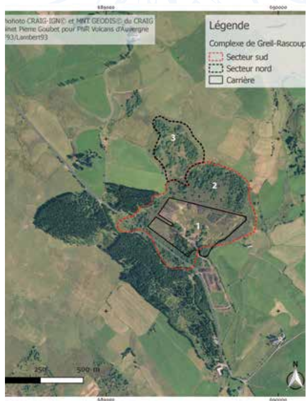
Vue aérienne de la tourbière de Greil-Rascoupet. Le complexe est exploité en carrière (front de taille et fond d'exploitation) sur une partie de sa surface [1]. Il était à l'origine constitué de deux unités fonctionnelles majeures, une au sud [2], constituant un édifice épais de 3-4 m de type haut-marais et une au nord [3], moins épaisse ou déjà fortement exploitée dans les années 1950, occupée par des canchaies ou des moliniaies. (● Cabinet Pierre Goubet)
