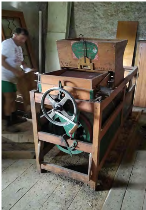
Essai de tri de graines prairiales à l'aide d'un vieux trieur de lentilles.
