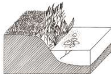
1. Profil de berge défavorable aux zonations de végétation
